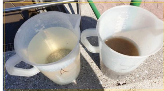
Ablauf nach der Anlage - Zulauf vom Kanal
